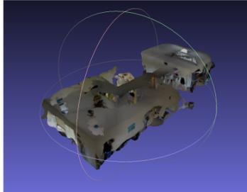
그림 1.1: OpenDroneMap으로 처리한 아파트의 3D 모델
